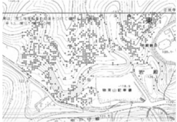
図12 ファーストパルスからラストパルスの距離が15m ~ 20mの点
