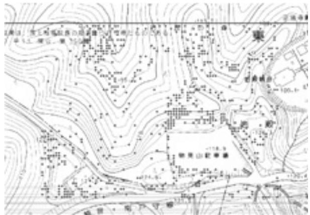
図14 ファーストパルスからラストパルスの距離が5m ~ 10mの点
