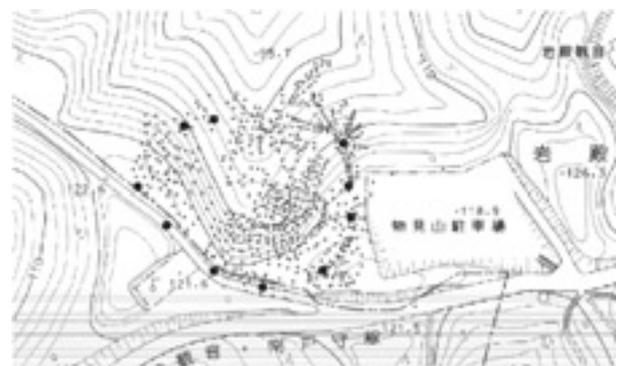
図19 基準点と地形測量点
