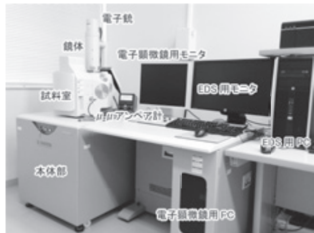
図 1 日立ハイテック社製走査型電子顕微鏡 (S-3400N) と Oxford Instruments 社製エネルギー分散型 X 線分析装置 (x-act)
