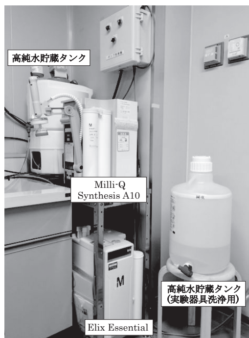
第 2 図 超純水製造システム
