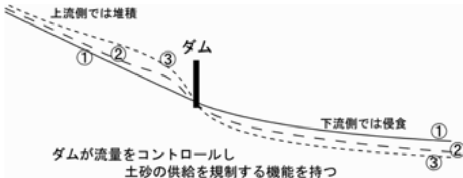
図8 ダムの影響が上・下流に影響を及ぼした地形変化の模式図
