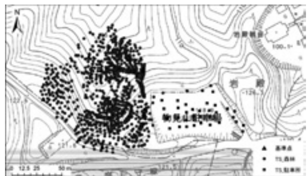
図10 TSによる現地測量 (約600点)
