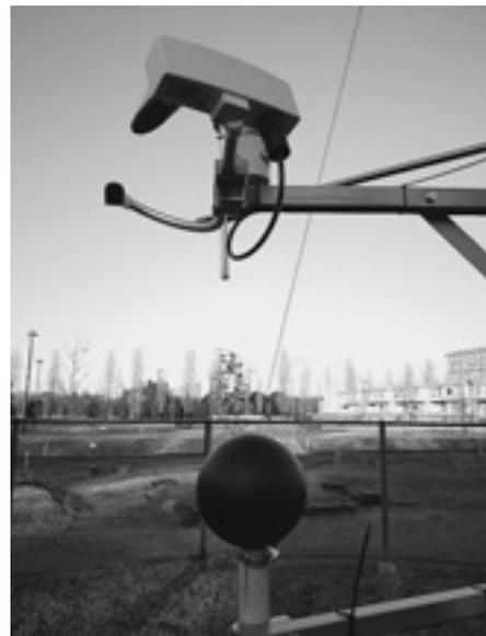
図14 総合気象観測システムに設置された現在天気計(上)と黒球温度計(下)
