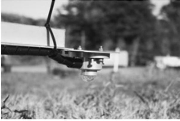
図10 放射・熱収支観測システムに設置された日射計
