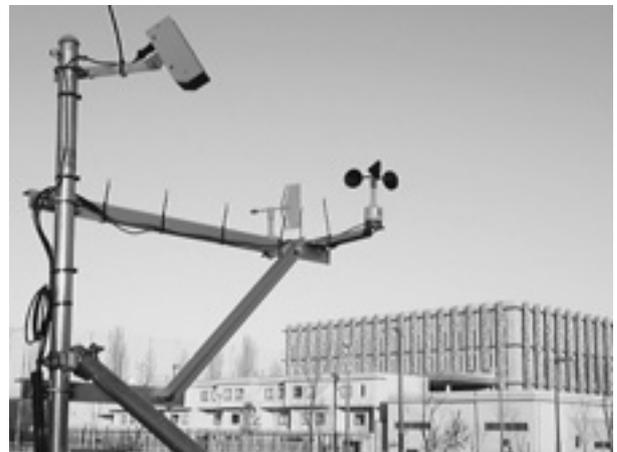
図8 放射・熱収支観測システムに設置されている放射温度計(左上)と風向計(中央)、風速計(右)
