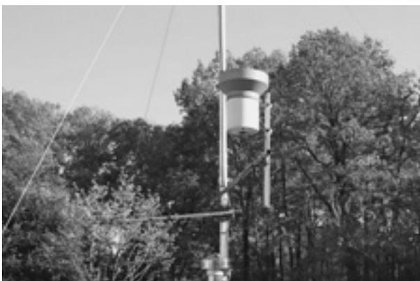
図6 総合気象観測システムに設置されている雨量計
