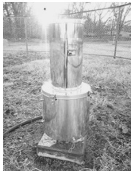
図15 総合気象観測システムに設置された雨量計と簡易酸性雨計測装置(下部)
