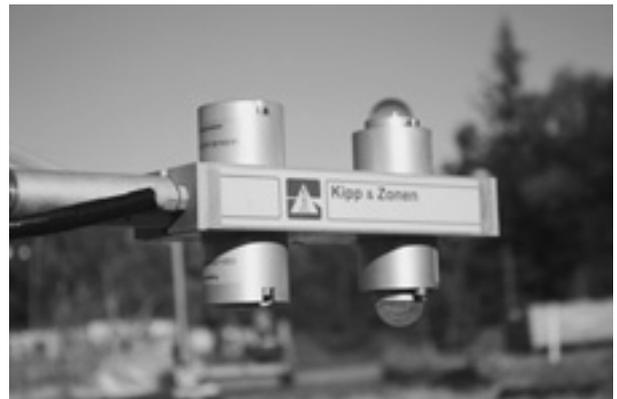
図9 放射・熱収支観測システムに設置されている正味放射計
