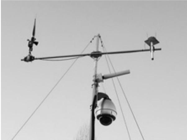
図4 総合気象観測システムに設置された風向風速計(左)、日射計(右)とWEBカメラ(下)。中央の棒状のものは無線LANの指向性アンテナである
