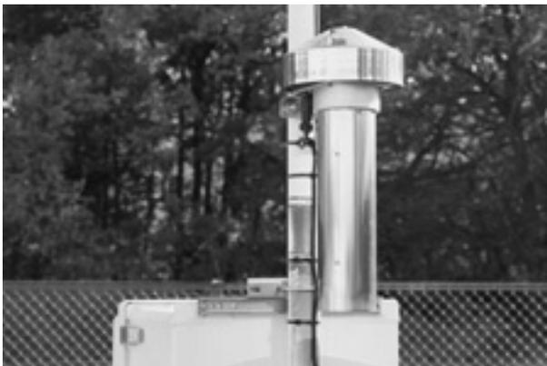
図5 総合気象観測システムに設置された強制通風筒。内部に温湿度センサーがある
