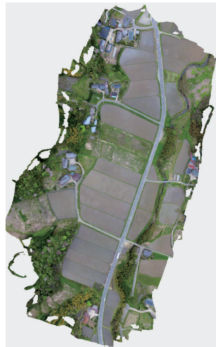
図7 高度145mの画像を用いたオルソ画像 (筆者作成)
