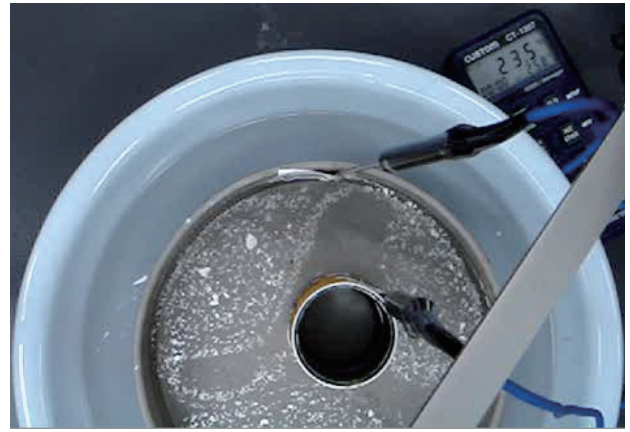
写真1 表面にアルミ粉を浮かべ中心部を冷却, 周辺部を加熱して水平温度差を与えた水槽を回転させる実験の様子. カメラは回転盤上に設置されている (立正大学学園新聞第111号 2010より, 渡来 靖講師 (現教授) 撮影).
