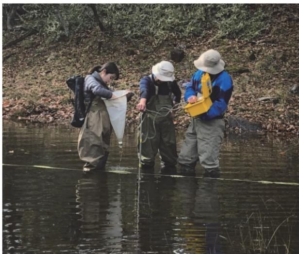
図7 「血の池」における *A. pacificus* の個体サンプルングの様子 (地点No.7; 2018年10月16日) 地点No.7においてはベリスタポンプ (GEO-pump-CFC-a, 株式会社地球科学研究所製) を用いて合計5深度から深度別の個体採取を行った。
