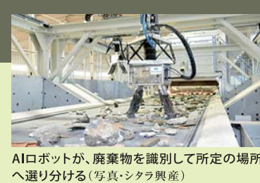
AIロボットが、廃棄物を識別して所定の場所へ選り分ける(写真:シタラ興産)
