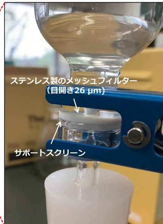
図3 地点N2の地下水からのMPsろ過;減圧ろ過用フィルターホルダー(ガラスタイプ)とアスピレーター。
