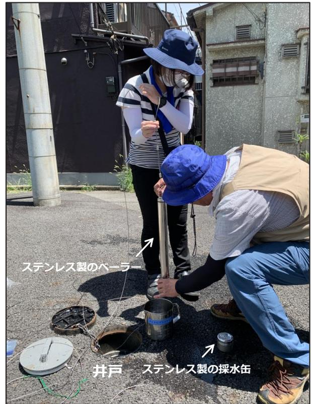
図2 地点N2におけるMPs分析用の地下水試料採水。
